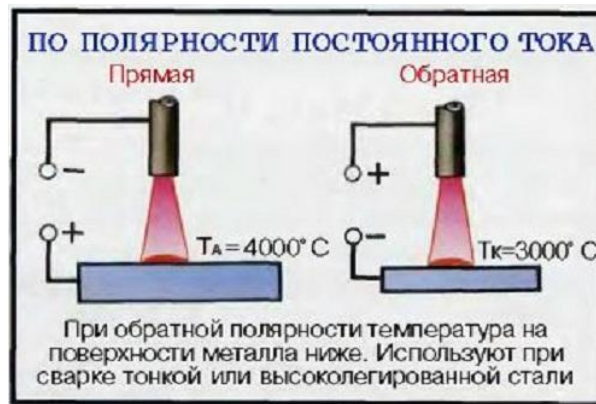
Рис. 8 - Виды сварочных дуг по полярности постоянного тока
